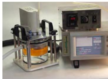
半導体製膜用回転電極装置
