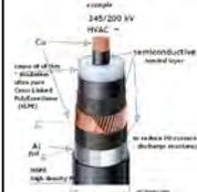
超高压電線に使用される架橋PE
