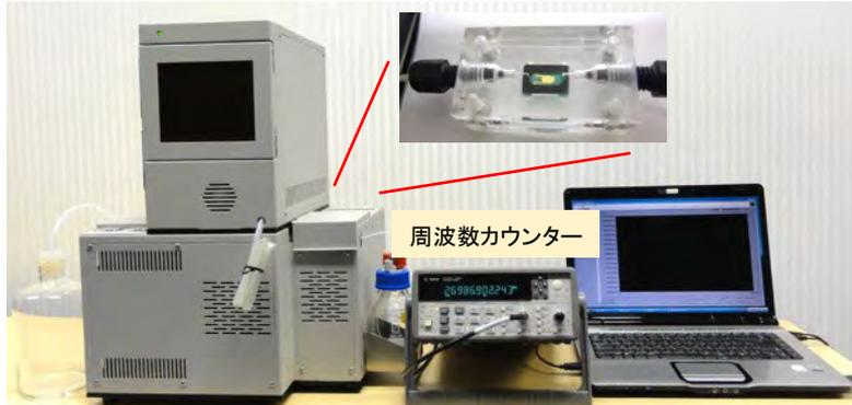
ICカード型の微量天秤センサー
