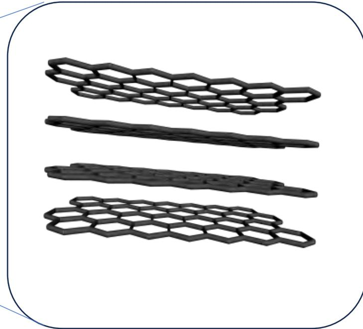
黒鉛を原子1個のレベルで拡大してみると、こんな感じの炭素原子出てきた面状の物質が積層した構造を持っています。
