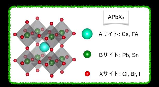
ペロブスカイトナノ結晶は、ナノメートルサイズの 有機無機ハイブリッド微粒子で、構成イオンや結晶 サイズを変えることで可視光から近赤外領域で発光 を制御できるユニークな発光材料です。
